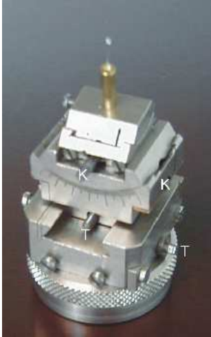
Abbildung 2: Goniometerkopf mit Glasfaden und aufgeklebtem Kristall. K: gekreuzte Eulerwiegen, T: gekreuzte Translationsschlitten.
